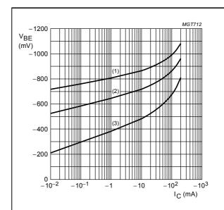
**BC857A;**  $V_{CE} = -5 \text{ V}.$
