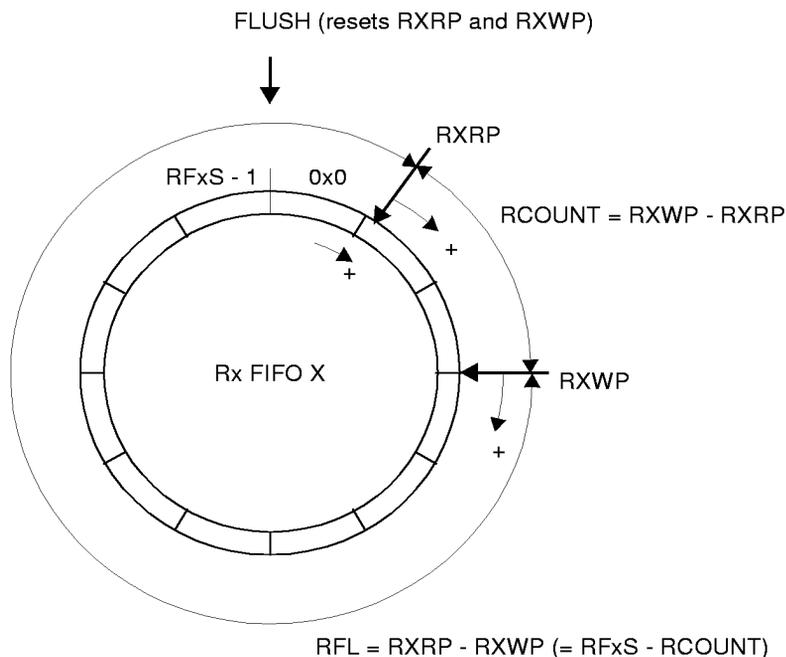
**Figure 18. Rx FIFO Operation**
